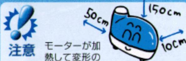
注意 モーターが加熱して変形の原因になります。吹出口から壁まで50cm以上、背面から壁まで10cm以上、上部から天井まで150cm以上離してください。
